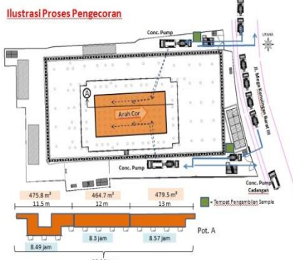
Gambar 3. Ilustrasi proses pengecoran mengatur penempatan concrete pump, parkir mobil mixer
