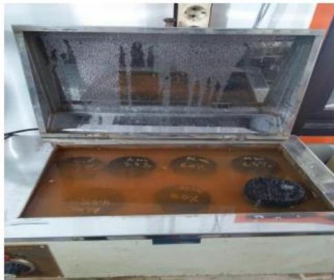
Gambar 3.7 Proses perendaman benda uji di dalam Waterbath
