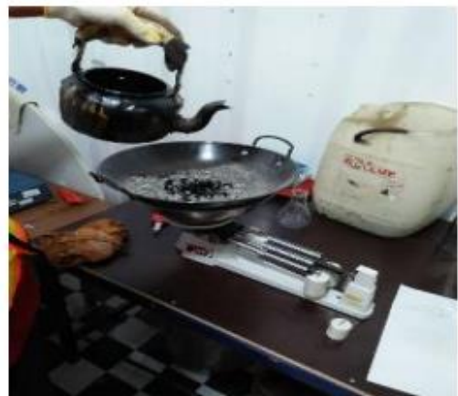
Gambar 3.2 Penimbangan dan pencampuran Agregat, limbah Styrofoam dan Aspal
