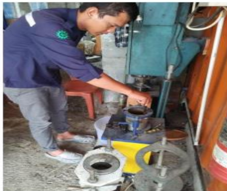
Gambar 3.4 Memasukan campuran beraspal ke dalam Mol
